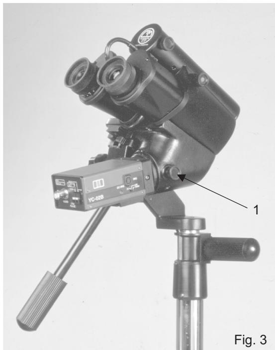
Con sistema óptico que permite la transmisión de video y la observación binocular simultáneamente manteniendo en foco ambas imágenes.
